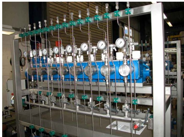
Zentrale Ölschmierung für Hochdruckverdichter
